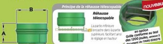
A partir de la deuxième réhausse empilée, la dalle de protection béton est nécessaire. Il est souhaitable que l'installation soit le moins profond possible pour faciliter l'entretien et éviter les surcharges de terre sur la cuve.
